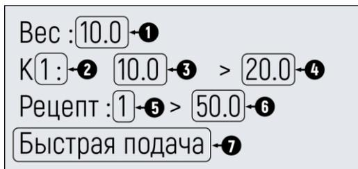
После запуска дозирования на экране контроллера отображается исчерпывающая информация о состоянии процесса дозирования в текущий момент: от названия текущего этапа цикла дозирования до текущего веса на весоизмерительной системе.
