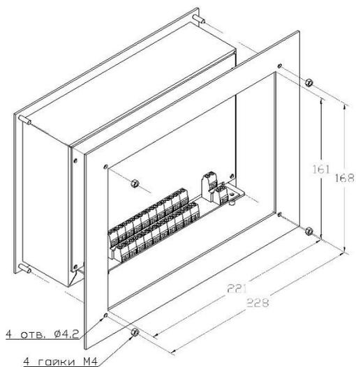
**Рисунок 2. Установка контроллера на лицевую панель шкафа управления**
