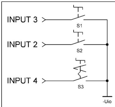
При запуске процесса дозирования контроллером предусмотрена функция слежения за состоянием выгрузной заслонки бункера, если она открыта запуск дозирования не происходит, и на экране появляется ошибка «Заслонка открыта».
