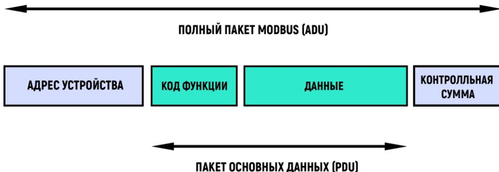
Обмен осуществляется при помощи полных пакетов данных, которые включают в себя адрес устройства и контрольную сумму (ADU).
