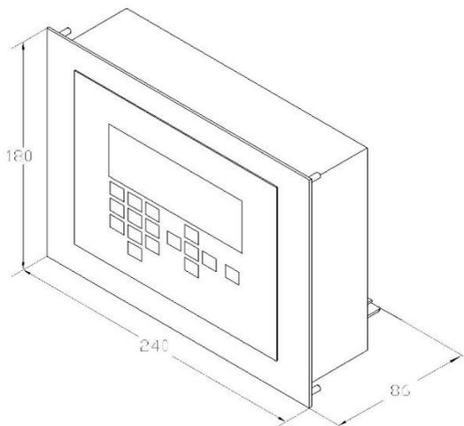
**Рисунок 1. Габаритные размеры**
