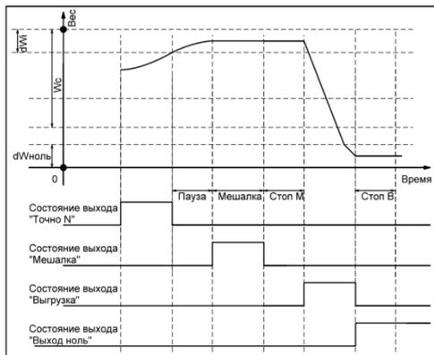
**Рисунок 15. Окончание дозирования компонента**
