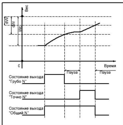
Рисунок 11. Принцип двухскоростного дозирования в режиме «скорость 1»
